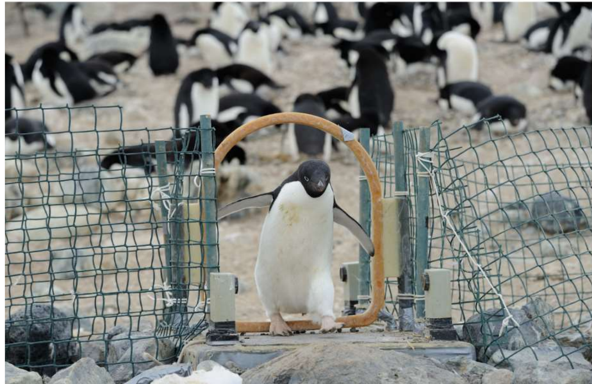
Automated weighbridge for Adélie penguins - journal.pone.0085291.g0 02 CC BY 4.0 Lescroël, A. L.; Ballard, G.; Grémillet, D.; Authier, M.; Ainley, D. G. (2014) - Lescroël, A. L.; Ballard, G.; Grémillet, D.; Authier, M.; Ainley, D. G. (2014). ...
